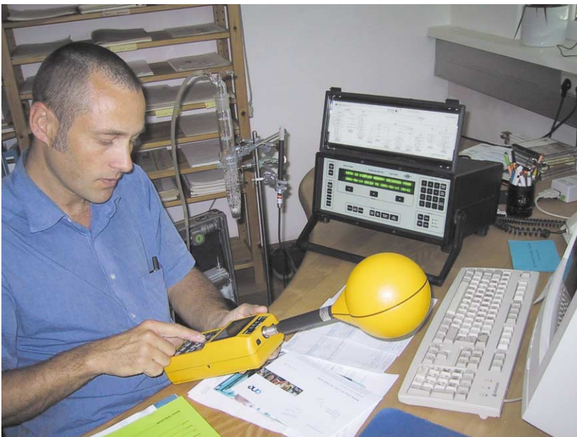
Abb. 1: Elektromagnetische Messung eines Computerarbeitsplatzes
