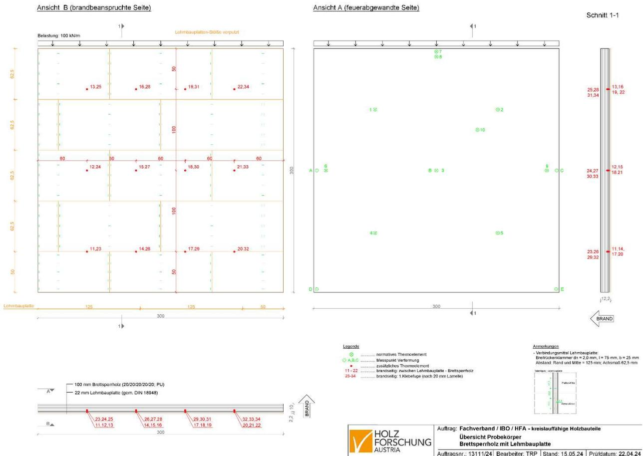
Abbildung 4: Konstruktionszeichnung der Brettsperholzwand
