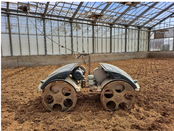
Abbildung 31: Wenderoboter der Fa. Egginger Naturbaustoffe zur Lehm-trocknung (Quelle: IBO)
