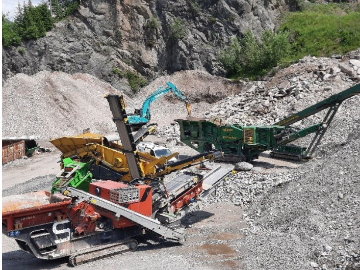
Abbildung 30: Mobile Siebanlage des Unternehmens Dödlinger Erdbau (Quelle: IBO)
