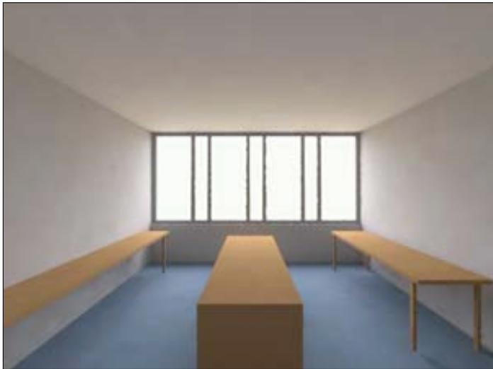
Abbildung 21: Lichtsimulation des Modellraums: Blick zur Fassade (stehend). Beliebig belichtete Darstellung.
