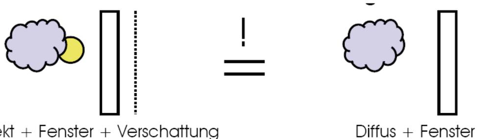
Abbildung 18: Begründung der Verwendung von Diffusstrahlungsdaten für die Untersuchung der Tageslichtnutzung.
