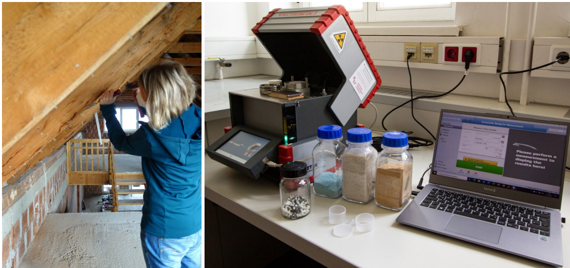
Beprobung eines Dachstuhl, Dämmstoffanalyse im stationären Labor (©Holzforschung Austria)
