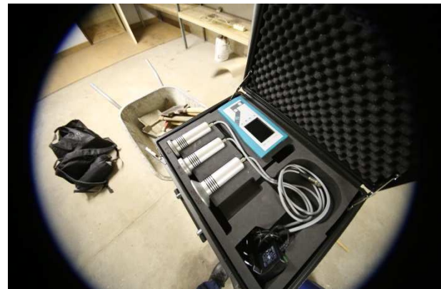
Abbildung 5: Mess-System zur zerstörungsfreien Erfassung der Feuchteverteilung im Mauerwerk
