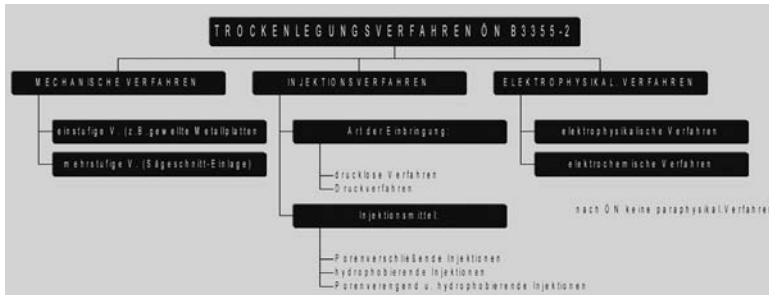
Abb 4: Übersicht der Trockenlegungsverfahren [Mück]
