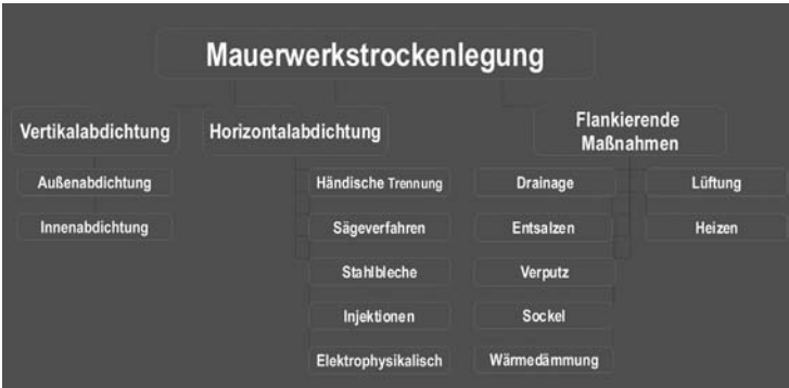
Abb. 2: Übersicht wichtiger Mauerwerksarbeiten [Mück]
