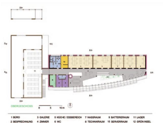
Die Lagerhalle wurde aus Brettsper Holz erstellt und ist leicht ergänzbar oder in Teilen austauschbar. Dem Bürogebäude ist im Norden durch Verlängerung des Gebäudedaches in diese Richtung eine überdachte Lager- und Zugangsfläche zugeordnet. So kann die Belieferung im Trockenen erfolgen, und Müll, Batterien und dergleichen können regengeschützt untergebracht werden.
