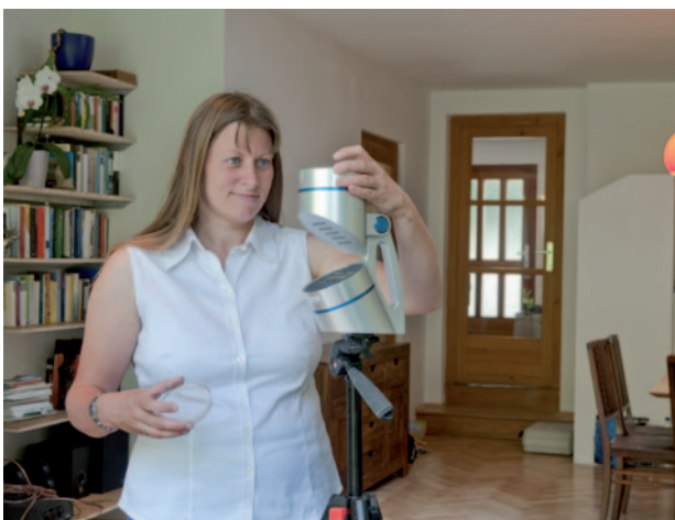
Messung der Schimmelpilzsporenkonzentration mittels Luftkeimsammler
