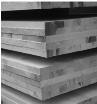
Unbesäumte Brettsperrholzelemente, die Thema des Forschungsprojektes waren.
