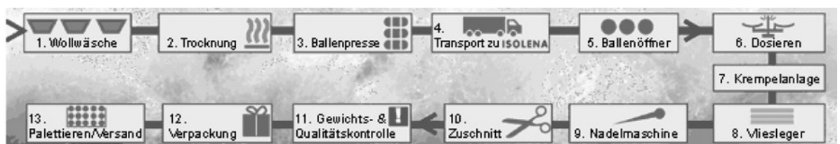
Abbildung 3: Produktionsschema ISOLENA Schafwolldämmung
