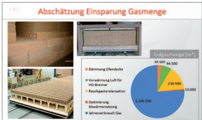
Abschätzung der Einsparung der Gasmenge in einem Ziegelwerk
