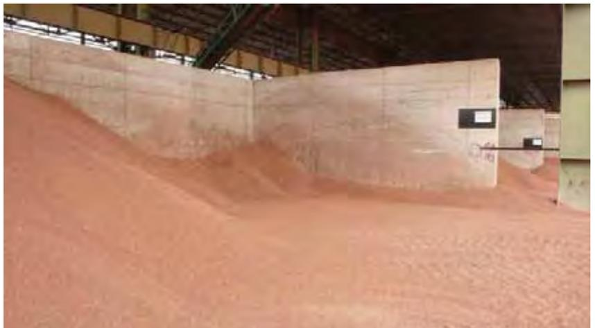
Abbildung 77: Recyclingziegelsplitt mit unterschiedlichen Korngrößen
