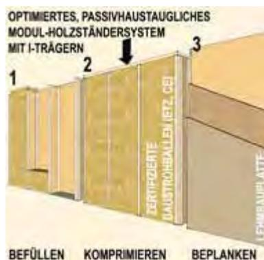
Abbildung 25: system/haus/bau Modulbauweise
