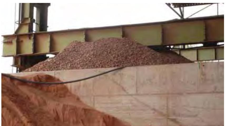
Abbildung 78: Ziegel/ Betongemisch für die Zementherstellung
