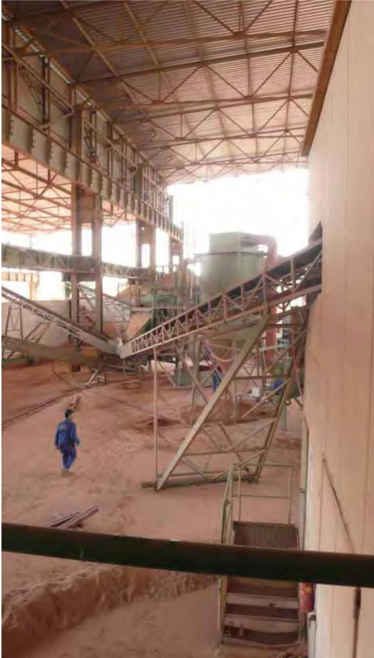
Das so vorbehandelte, gereinigte und aussortierte Ziegelmaterial kann dann in einem Brecher zu Ziegelsplitt unterschiedlicher Korngröße gebrochen werden.
