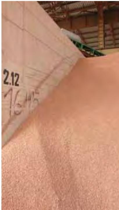
Abbildung 76: Recyclingziegelsplitt hoher Qualität mit definierter Korngröße
