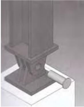
Abbildung 91: Einschieben eines Bolzens in eine Gelenkbolzenverbindung
