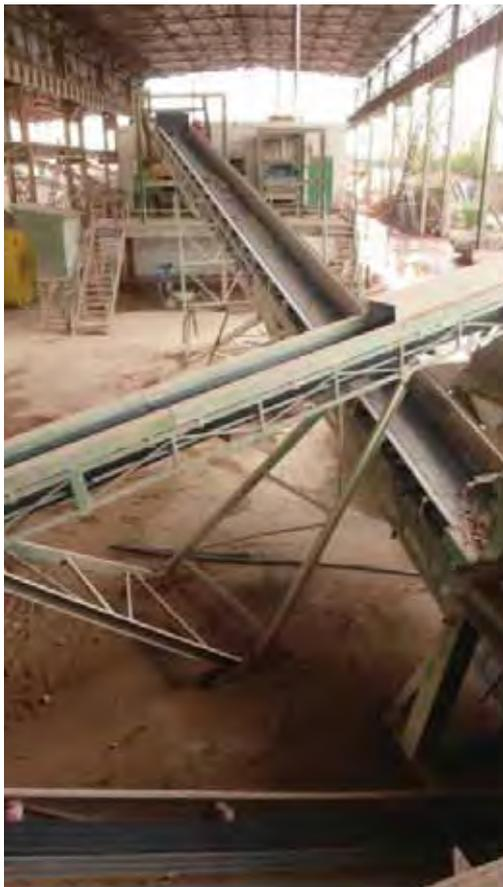
So vorbereitet werden die mineralischen Teile auf einem Förderband händisch sortiert. Je nach Fraktion und zukünftigem Verwendungszweck sind mehr oder weniger Leute gleichzeitig an der händischen Sortierung beteiligt.
