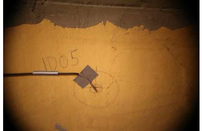
Abbildung 70: Messpunkt Feld 05, Innendämmsystem 05, Temperatur und relative Feuchte. Mess-System Eaton.
