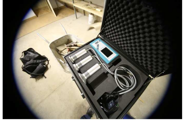
Abbildung 44: Mess-System zur zerstörungsfreien Erfassung der Feuchteverteilung im Mauerwerk
