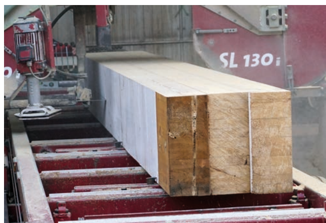
Abb. 1: Remanufacturing eines gebrauchten und beschichteten Brettschichtholzträgers (© Holzforschung Austria)
