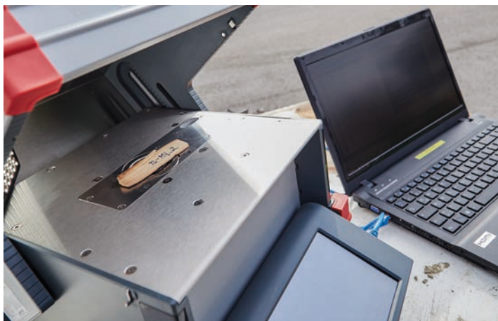
Abb. 4: Eine gute Ergänzung zur Untersuchung im Labor der Holzforschung Austria ist die mobile Analyse mittels Röntgenfluoreszenz für schnelle Entscheidungen vor dem Rückbau (© ACR/schewig-fotodesign.at)
