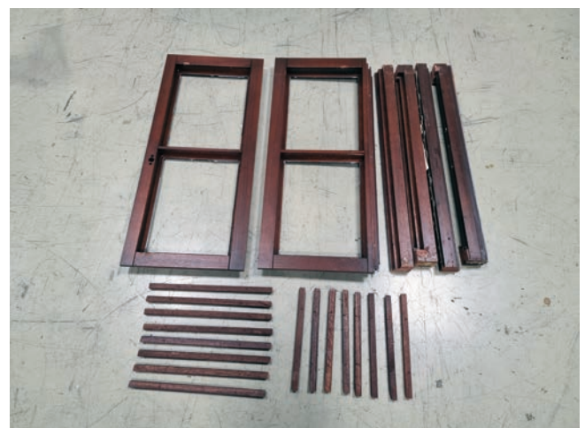
Abb. 3: Zerlegung kleinvolumentlicher Holzbauprodukte im Zuge der Analyse des Aufwandes und der Ausbeute (© Holzforschung Austria)
