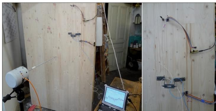
Abb. 2: Versuchsaufbau an CLT mit Vorsatzschale und Shaker für die Körperschallanregung (links) und Aufnehmerpaare an den Messpunkten 1 und 2 (rechts)
