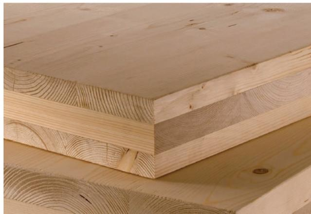
CLT ist ein Massivholz-Bauprodukt, das aus mindestens drei Lagen kreuzweise verklebter Einschichtplatten hergestellt wird.
