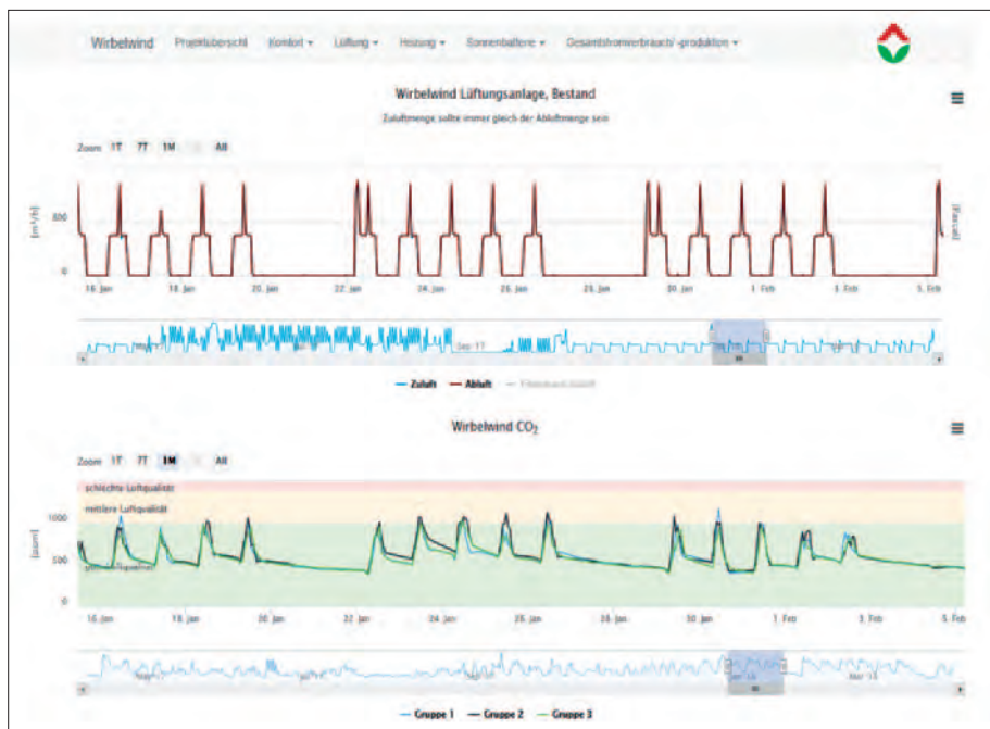
Abb. 4: Überwachung der Zu- und Abluftmengen sowie CO 2 -Konzentration in den Gruppenräumen.
