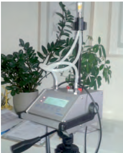
Abb. 1: Messgerät (BiVOC) zur Erhebung der Formaldehyd-konzentration in der Raumluft
