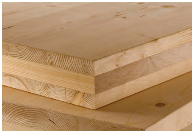
CLT ist ein Massivholz-Bauprodukt, das aus mindestens drei Lagen kreuzweise verklebter Einschichtplatten hergestellt wird. Quelle: Stora Enso Wood Products Austria
