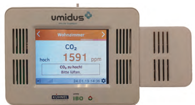
Abb. 5: Klartextanzeige zum „Innenraumlüftungsproblem“
