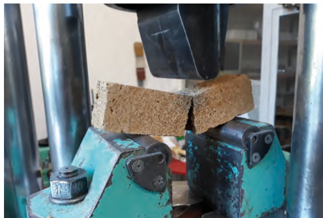
Abb. 8: Biegezugfestigkeitsprüfung eines Lehmprismas (BTI)
