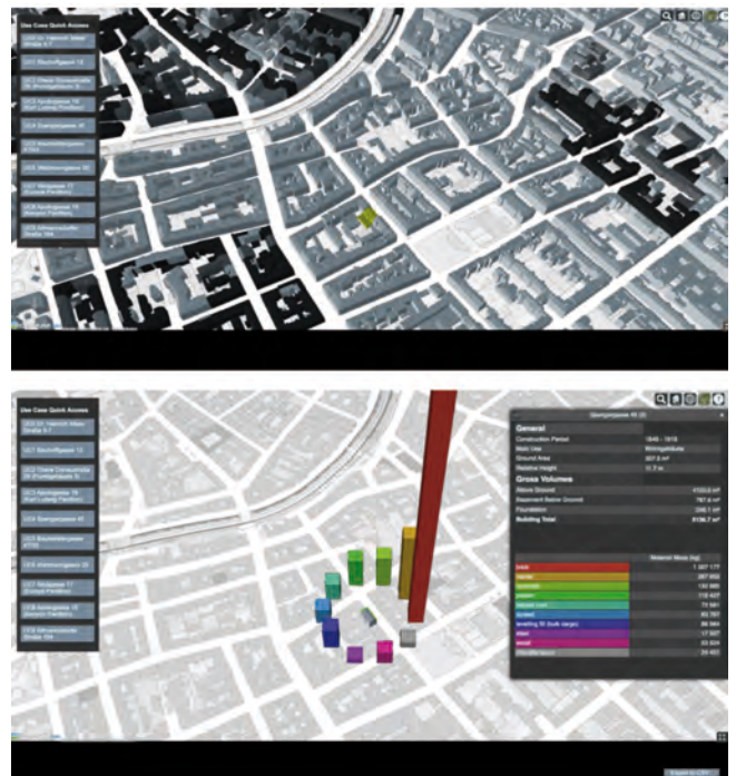
Abb. 2: Überblicksdarstellung der 3D Modelle der Stadt Wien (LOD 2.1). Durch Anwahl eines Gebäudeteils kann die Hochrechnung der materiellen Zusammensetzung visualisiert werden, alle Berechnungsdaten sind als Tabellen exportierbar (Quelle: TU-VC)
