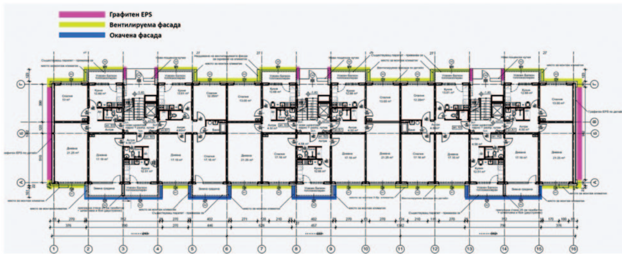
Abb. 2: Sanierung aller Gebäudekonstruktionen und -anlagen, hinterlüftete und wärmedämmte Fassaden, abgehängte Fassaden zur Umwandlung von Balkonen und Loggien in „Wintergärten“
