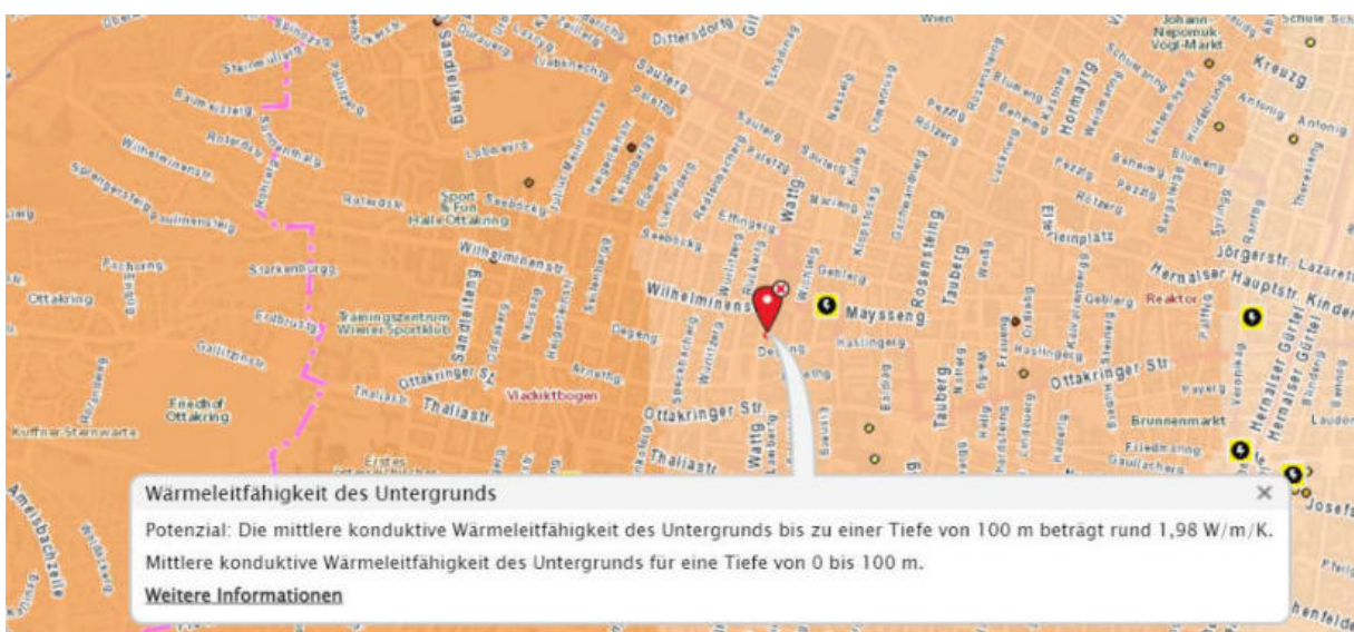
Abbildung 10-144: Erdwärmepotential (Wärmeleitfähigkeit des Untergrunds), Wattgasse 26-32/Wichtelgasse 39, 1160 Wien (© Stadt Wien)
