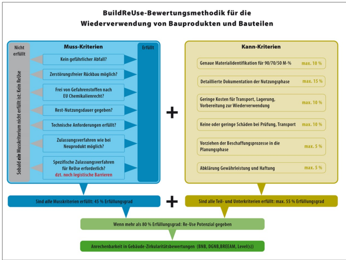
Abbildung 9: Im Rahmen des Projekts „Build Re-Use“ entwickeltes Bewertungsprinzip zur Wiederverwendung von Bauprodukten und Bauteilen (Meissner et al. 2024)
