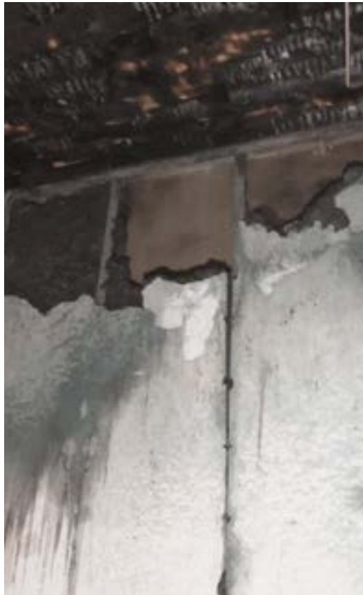
Abb. 4.15 Prüfkörper nach Brandversuch und Löschangriff
