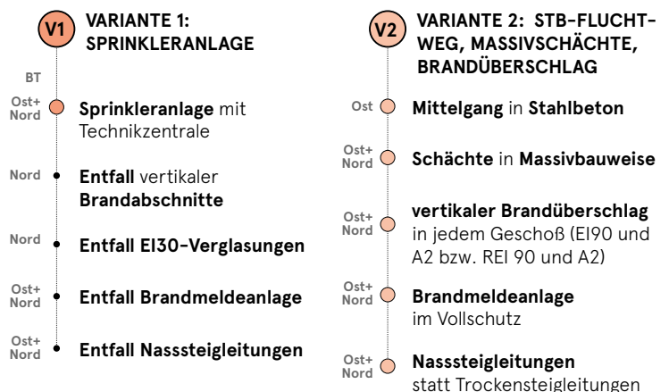
Abb. 4.5 KSB-Varianten 1+2 zur Erlangung einer Baubewilligung
