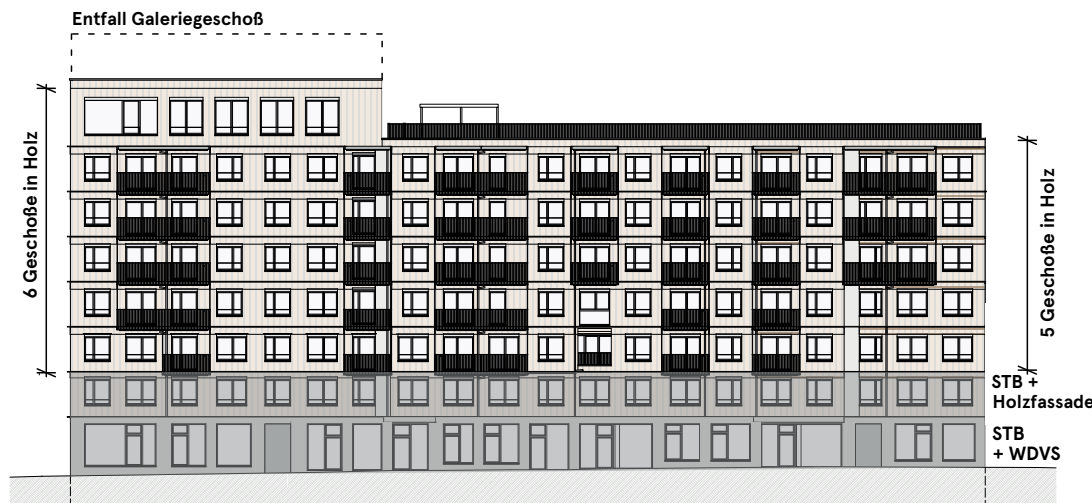
Abb. 4.9 Ansicht Nordfassade mit den geplanten Brandschutz- Anpassungen
