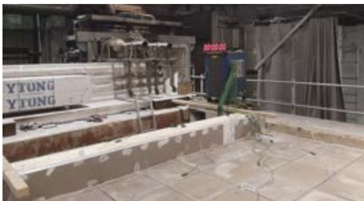
Abb. 4.11 (links) Decke und Außenwand im Brandversuch
