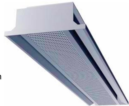
Der DID300B kann zur Kühlung und/oder zur Heizung eingesetzt werden. Zur Absaugung von Abluft kann ein zusätzlicher Anschlussstutzen neben der Gehäusekammer für die Primärluft angeordnet sein (Zu- und Abluft-Ausführung).“ (Trox-Technik, [www.trox.de](http://www.trox.de), Deckeninduktionsdurchlässe Serie DID300B) Ausschreibungstext für das Produkt, das für die Simulationen angenommen wurde:
