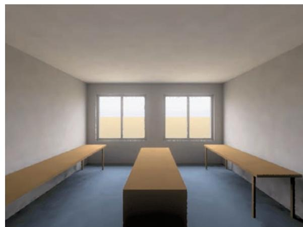
Abbildung 10: Variante Fenstergröße 20 % der Grundfläche, ohne Sturz (links), mit Sturz (rechts). Quelle: Alware
