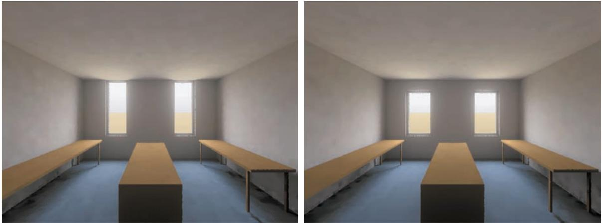
Abbildung 11: Variante Fenstergröße 10 % der Grundfläche, keine Sturz (links), mit Sturz (rechts). Quelle: Alware
